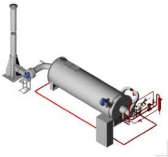
**Печи трубчатые** предназначены для нагрева углеводородного сырья, путем открытого огневого обогрева трубчатого змеевика газами в топочной камере от сгорания жидкого или газообразного топлива.
